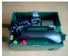
Fot. 3. Polowy aparat telefoniczny AP-82/MB-CB. Źródło: Zasoby własne Bds.P.
