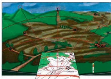
Rys. nr 8. Przykład przeprowadzenia orientowania topograficznego. Źródło: Poradnik metodyczny do szkolenia z terenoznawstwa - Szkol. 898/2014.
