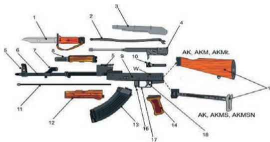
Rys. 1. Zasadnicze zespoły i części karabinków AKM (AKML), AKMS (AKMSN) i AK.
