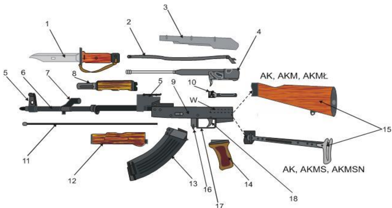
Rys. 13. 1- bagnet 2- urządzenie powrotne 3- pokrywa komory zamkowej 4- suwadło z tłokiem gazowym 5- przyrządy celownicze (muszka, szczerbinka) 6- lufa 7- komora gazowa 8- rura gazowa z nakładką termiczną 9- komora zamkowa z mechanizmem spustowym i przełącznikiem rodzaju ognia 10- zamek 11- wycior 12- łożo 13- magazynek 14- rękojeść 15- kolba (drewniana, metalowa składana)
