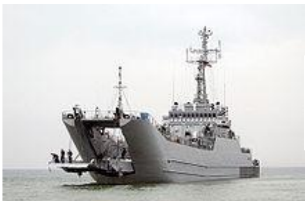
Fot. 8. ORP Poznań Transporter pływający PTSM opuszczający okręt ORP "Poznań" projektu 767 za pomocą furty dziobowej.
