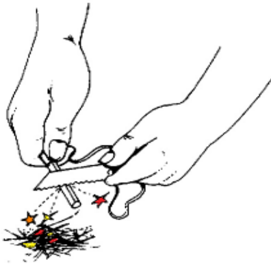
Rys. 21. Rozniecanie ognia bez zapalek za pomocą krzesiwa i stali.
