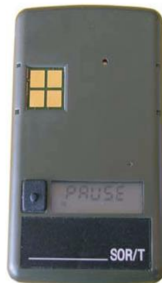
Fot. 23. Dawkomierz indywidualny SOR/T/widok płyty czołowej
