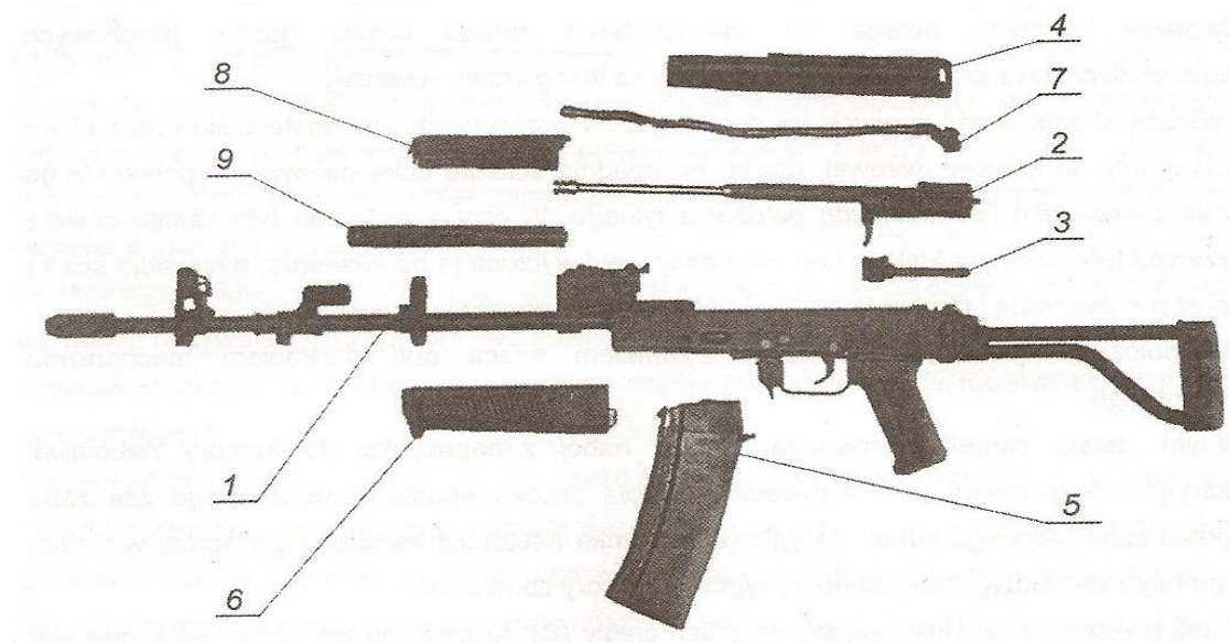
Rys. 29. Zasadnicze części i mechanizmy karabinu.
