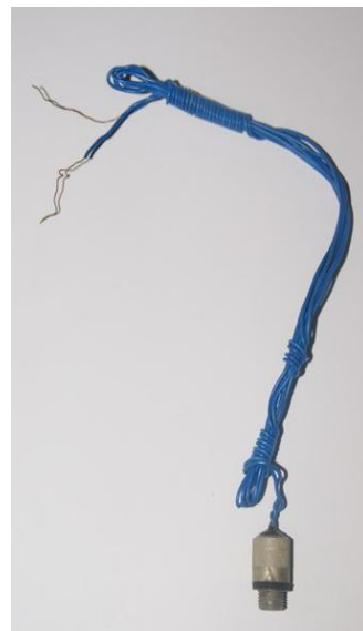
Fot. 122. Zapalnik elektr.
