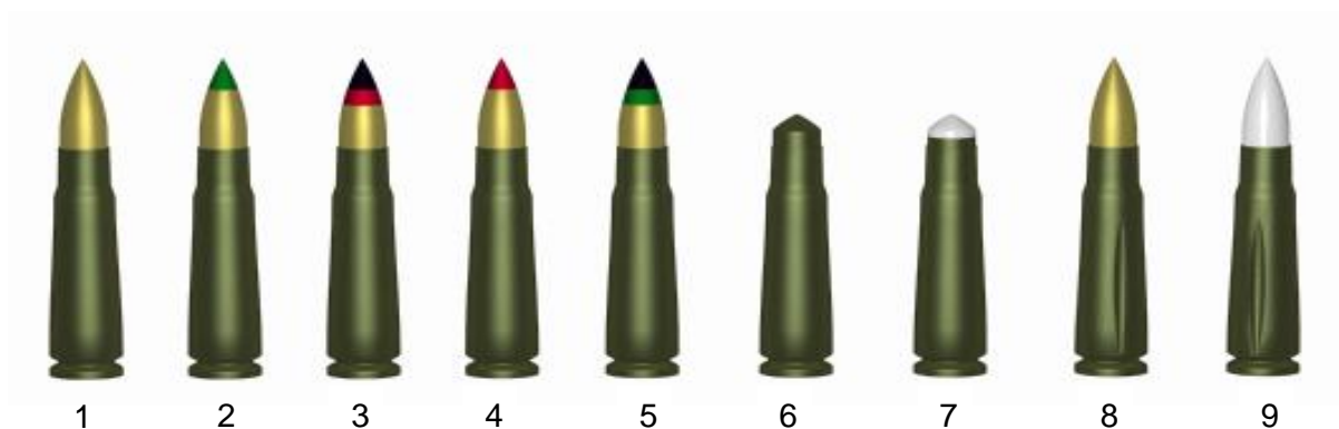
Rys. 32. 7,62mm naboje wz 1943: 1 – z pociskiem zwykłym PS, 2 – z pociskiem smugowym T- 45, 3 – z pociskiem przeciwpancerno – zapalającym BZ, 4 – z pociskiem zapalającym Z, 5 – z pociskiem o zmniejszonej prędkości US, 6 – nabój miotający UNM, 7 – nabój ślepy, 8 – nabój szkolny, 9 – nabój treningowy.
