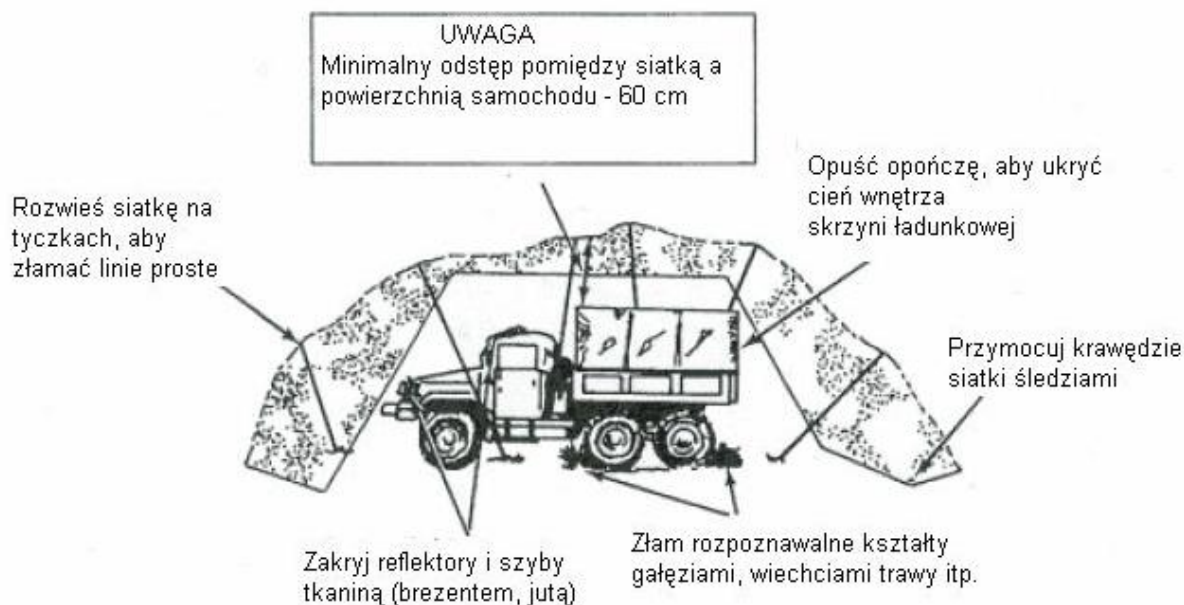
Rys. 38. Sposób maskowania pojazdu za pomocą siatki maskującej (maski).
