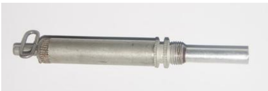
Fot. 111. Zapalnik naciskowy do miny PMD-6 (PMD-6M) składający się z: mechanizmu uderzeniowego MUW oraz zapału MD-5M.
