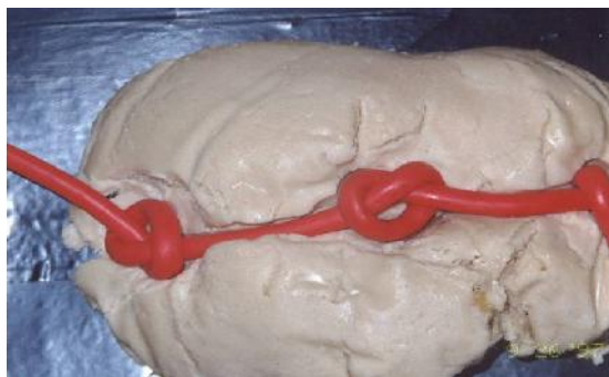
Rys. 51. Plastyczny materiał wybuchowy uzbrojony lontem detonującym.
