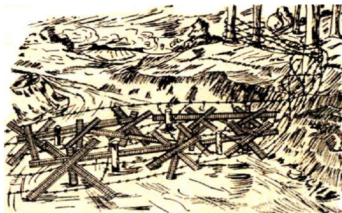
Rys. 84. Zapora z jeży metalowych
