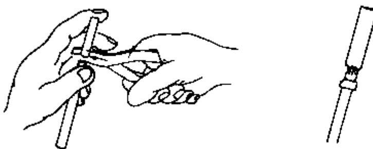
Rys. 57. Wykonanie zapalnika- zespolenie spłonki pobudzającej z lontem prochowym.
