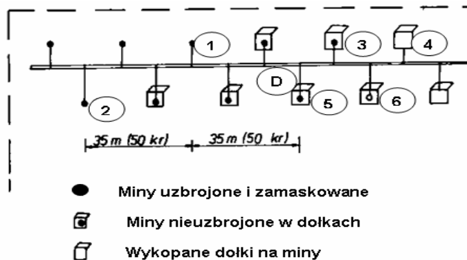
Rys. 72. Organizacja pracy drużyny podczas zakładania przeciwpancerneho pola minowego za pomocą taśmy minerskiej rozwijanej równolegle do frontu pola minowego.
